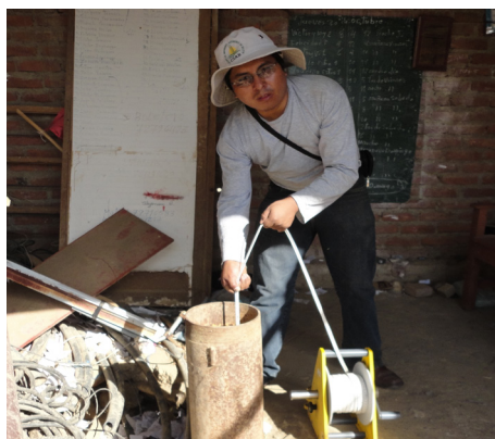
Figura 13. Medición del nivel estático en un pozo de observación
